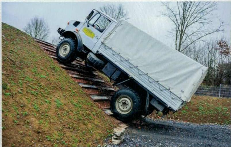
**Kurz und knackig:** Die Auffahrt ist zum Laufen fast schon zu steil. Bahnschwellen mit aufgeschraubten Stahlwinkeln sorgen für Grip und erhalten die Strecke.
